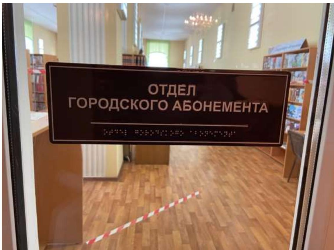
Рисунок 9. Тактильная табличка с обозначением помещения
